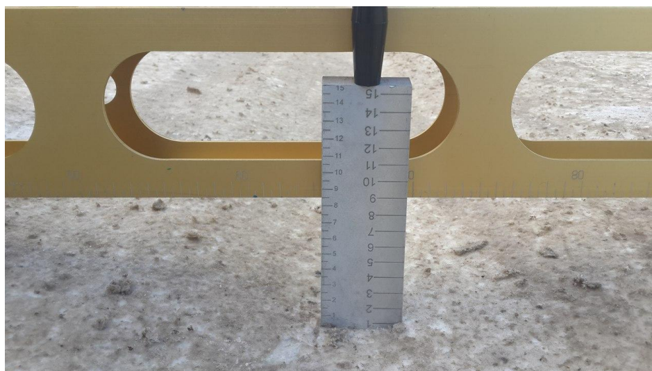
Рис. 2 Замер глубины колеи с помощью клинового промерника
