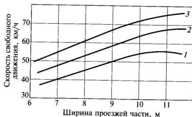
Рис. 1. Зависимость скорости свободного движения транспортных средств от ширины проезжей части в зимних условиях: 1 – 50%-ной обеспеченности; 2 – 85%-ной обеспеченности; 3 – 95%-ной обеспеченности
