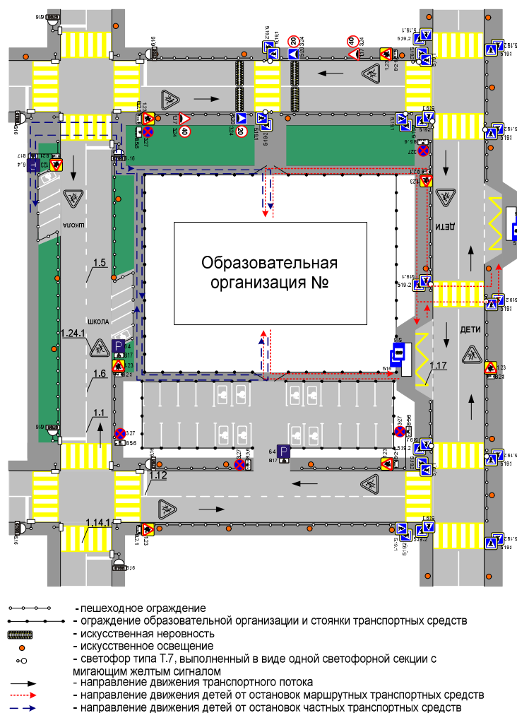
Рис. 4. Схема ОДД в зоне образовательного учреждения (организации)
