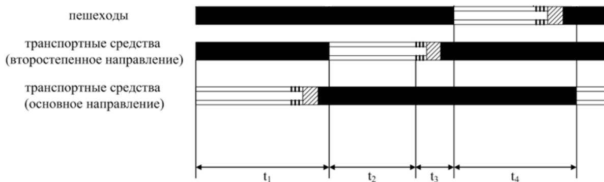
Рис. 2. Структура цикла режимов регулирования на перекрестке с вызывным автомобильным устройством
