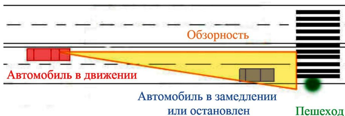
Рис. 2. Принципиальная схема «треугольника видимости» в системе ВПАДС
