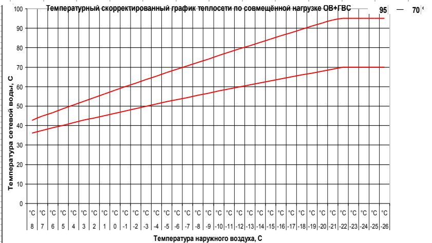
— Температурный режим работы наружной теплосети 95,911 — 70 °С по графику центрального качественного регулирования по совмещенной нагрузке отопления и ГВС
