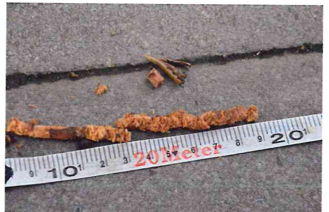
Рисунок 10 – Керн дерева тополя №2, на котором видно, что внутри дерева гниль
