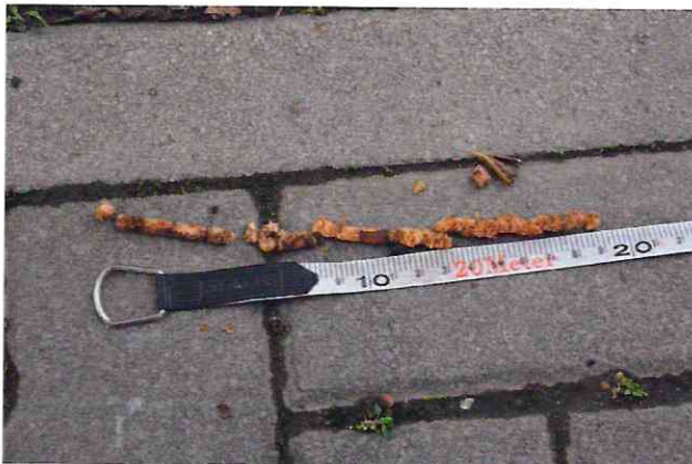
Рисунок 10 – Керн дерева тополя №2, на котором видно, что внутри дерева гниль
