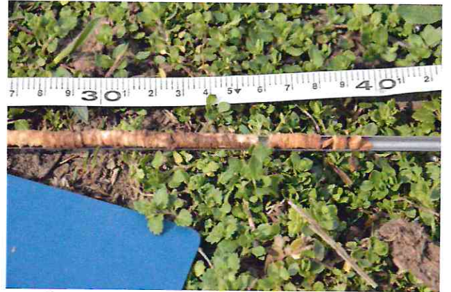
Рисунок 5 – Керн дерева тополя №1 (на втором фото видно, что внутри дерева гниль)
