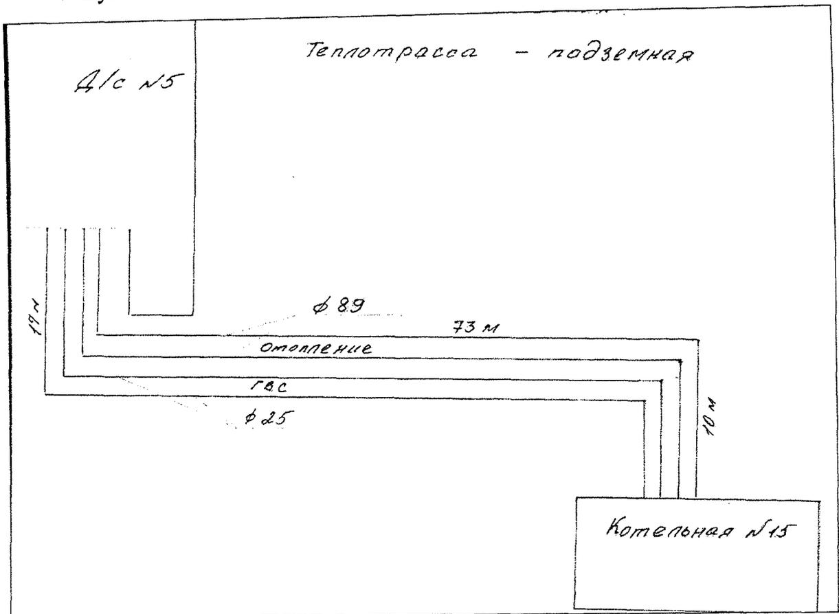
Рисунок 19 Схема теплотрассы от котельной № 25 ст. Павловская
