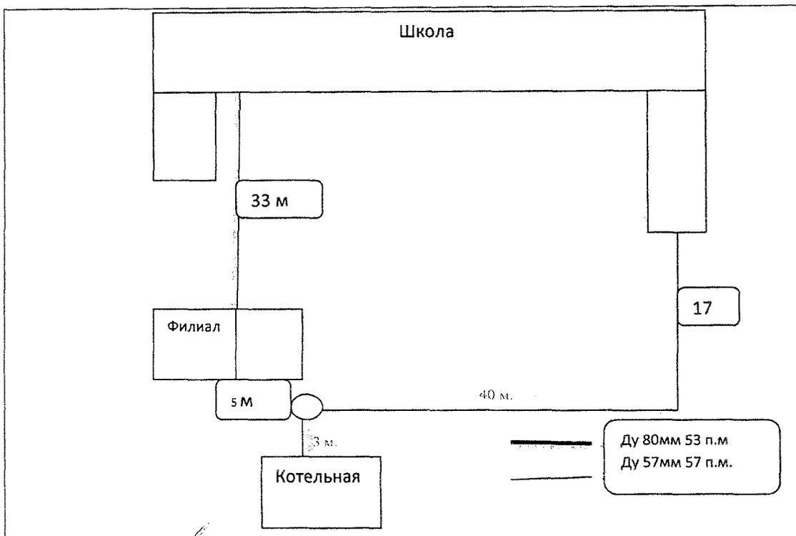
Рисунок 20 Схема теплотрассы от котельной № 29 ст. Павловская
