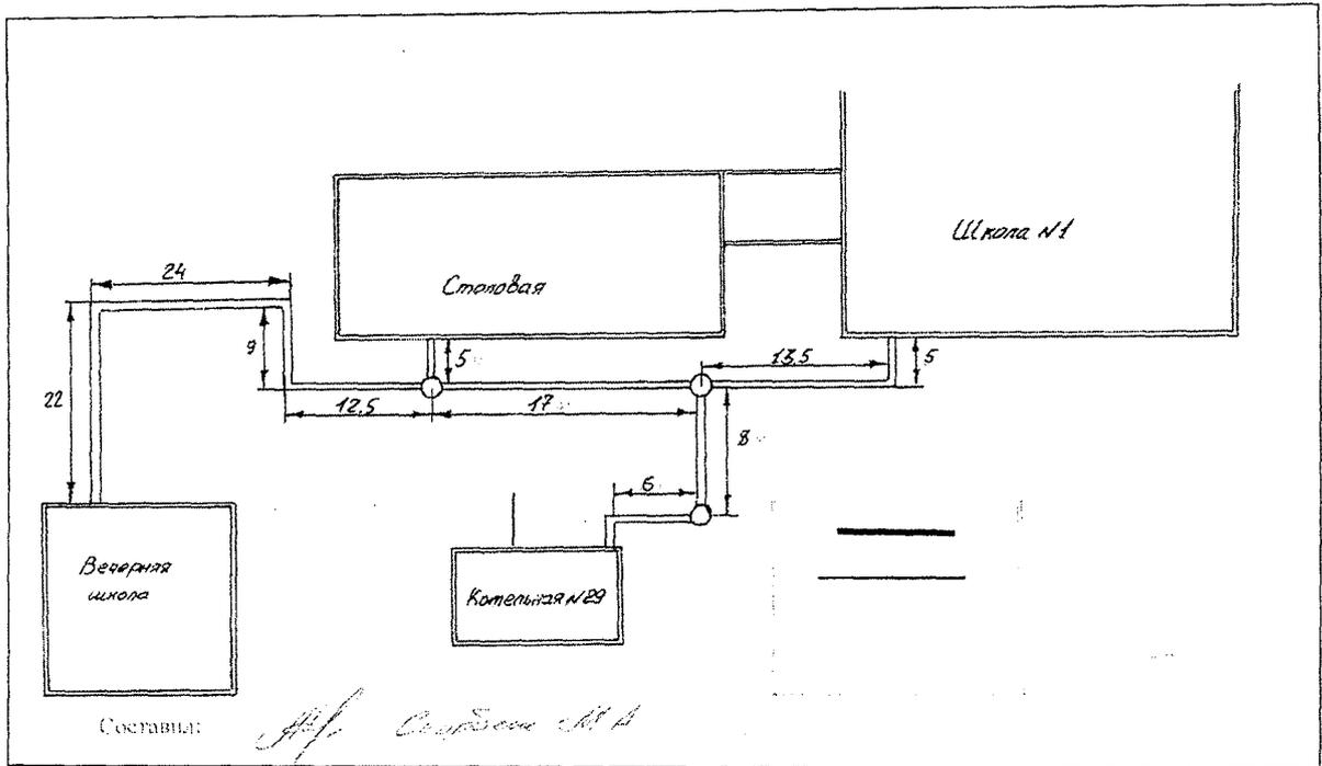
Рисунок 21 Схема теплотрассы от котельной № 32 ст. Павловская
