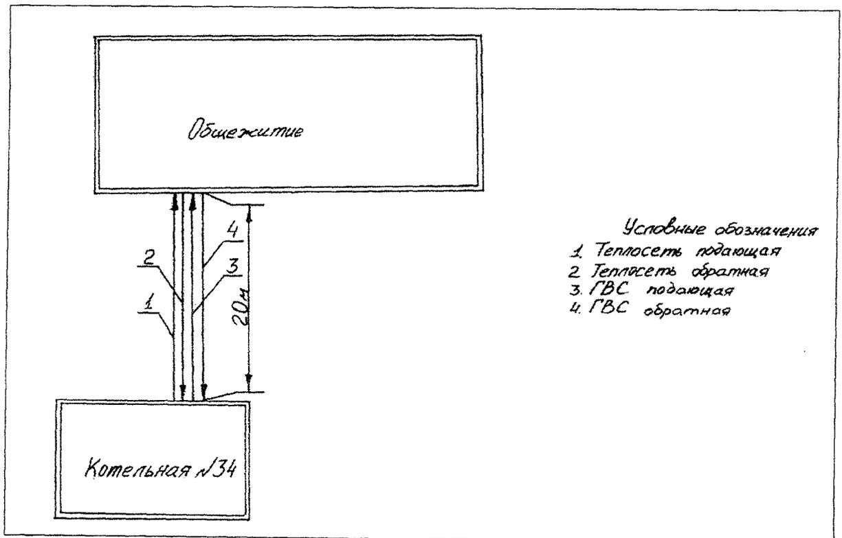
Рисунок 24 Схема теплотрассы от котельной № 17 с. Краснопартизанское
