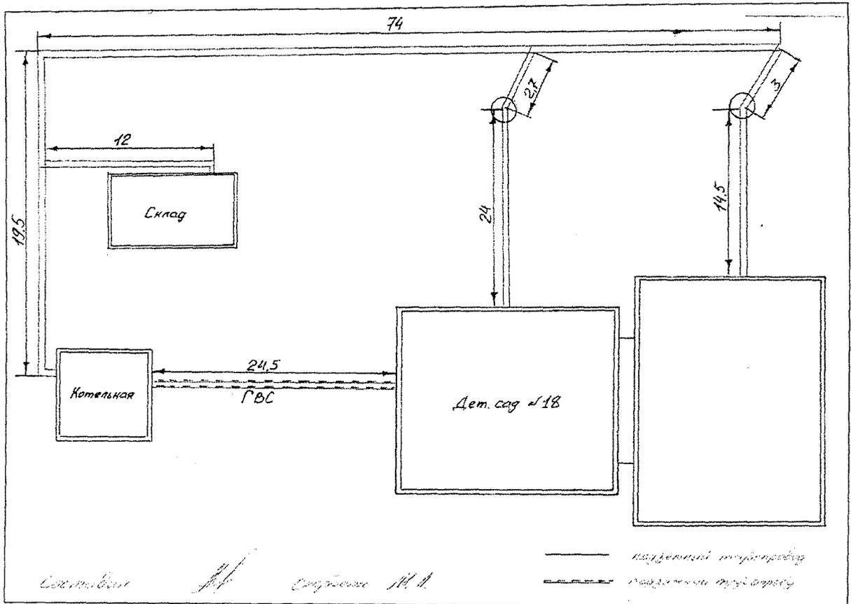
Рисунок 23 Схема теплотрассы от котельной № 34 ст. Павловская
