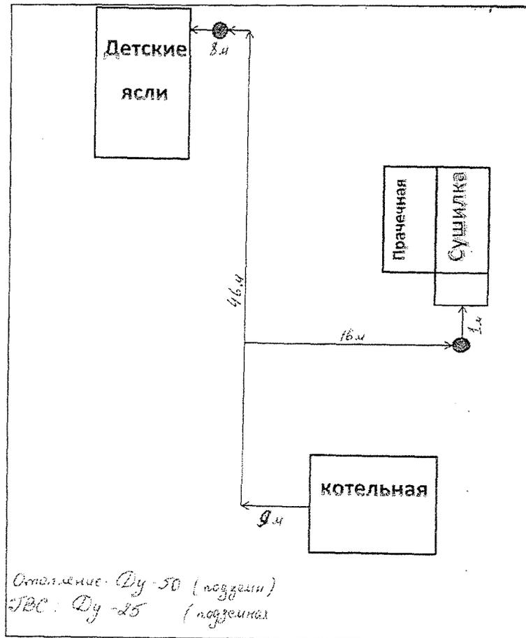
Рисунок 22 Схема теплотрассы от котельной № 33 ст. Павловская
