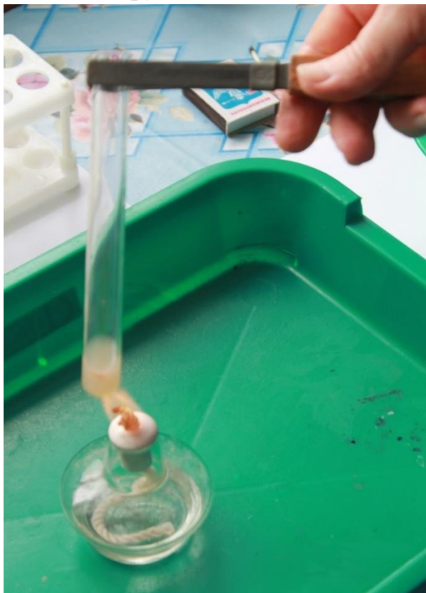
Рис. 5 Нагревание вытяжки шоколада с азотной кислотой
