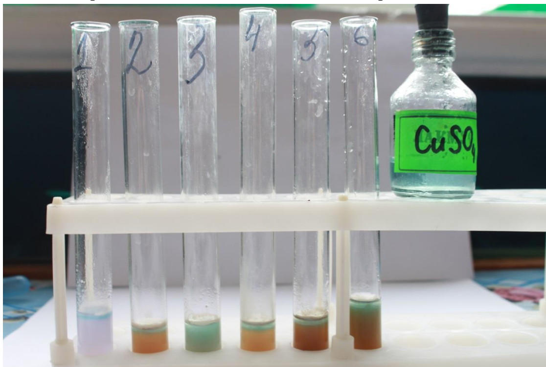
Рис.4 Результат реакции по определению углеводов
