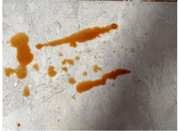
Рисунок 2 1 Образование брызг на поверхности керамической плитки
