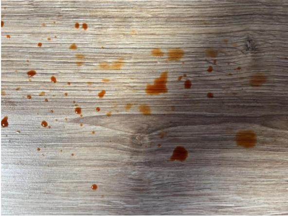
Рисунок 1 Образование брызг на деревянной поверхности
