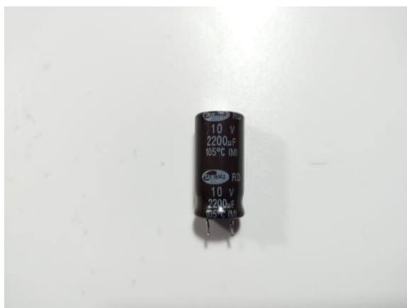
Рисунок 3. Конденсатор электролитический ёмкостью 2200мкФ
