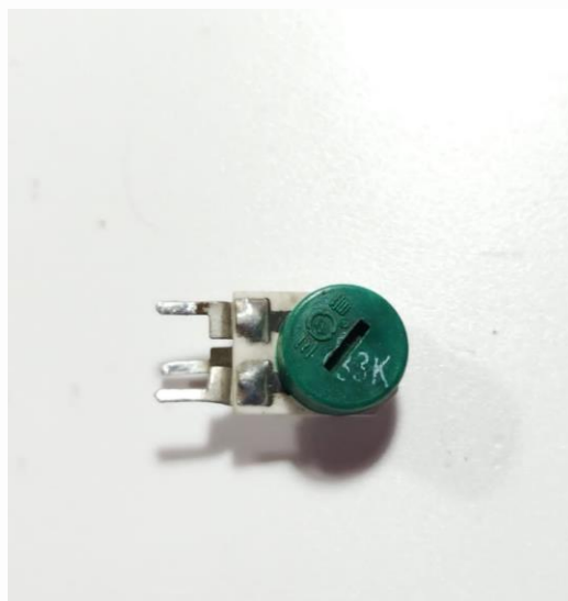
Рисунок 6. Подстроечный резистор сопротивлением 33 кОм
