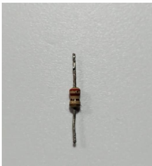
Рисунок 5. Резистор сопротивлением 220 Ом
