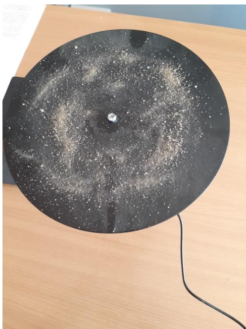
Рисунок3 Фигуры Хладни на круглой пластине
