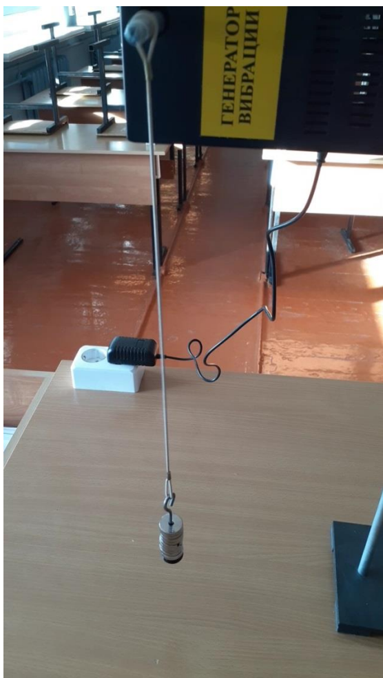
Рисунок1. Установка для демонстрации механического резонанса
