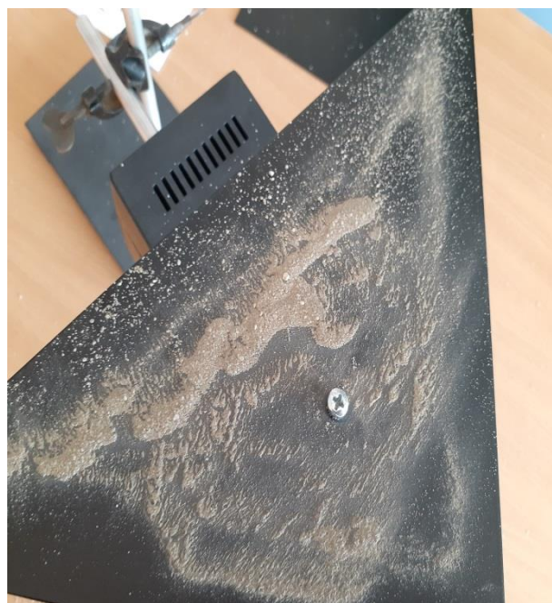
Рисунок4 Фигуры Хладни на треугольной пластине
