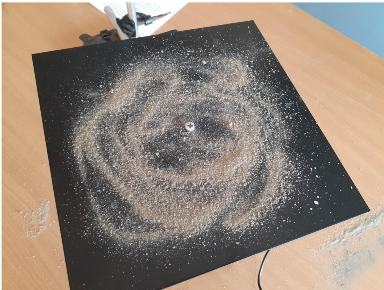
Рисунок 1 Получение фигур Хладни на прямоугольной пластине
