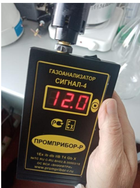
Рисунок1 Определение количества угарного газа при горении фольгированного утеплителя.
