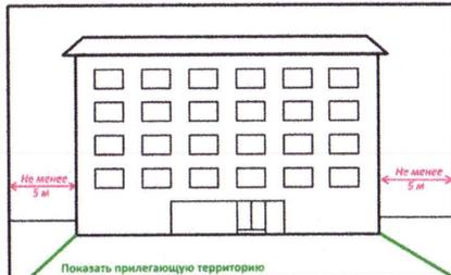
Схема размещения рекламной конструкции (ситуационный план)
