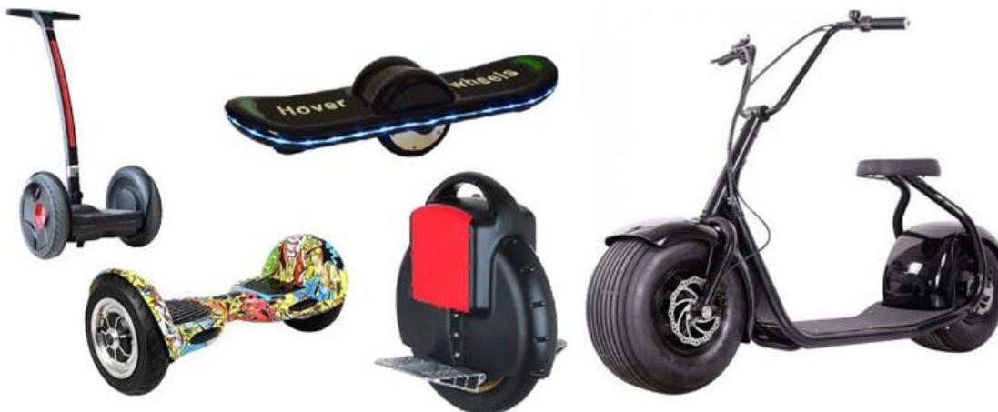
Нередко на наших улицах можно встретить новые популярные средства передвижения как сигвей, гироскутер и моноколесо. Все перечисленные средства имеют электрический двигатель, различную мощность и оснащены специальными датчиками, которые автоматически поддерживают равновесие.
