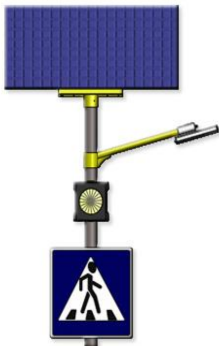
Рисунок 58 Комплект освещения пешеходного перехода на солнечных электростанциях
