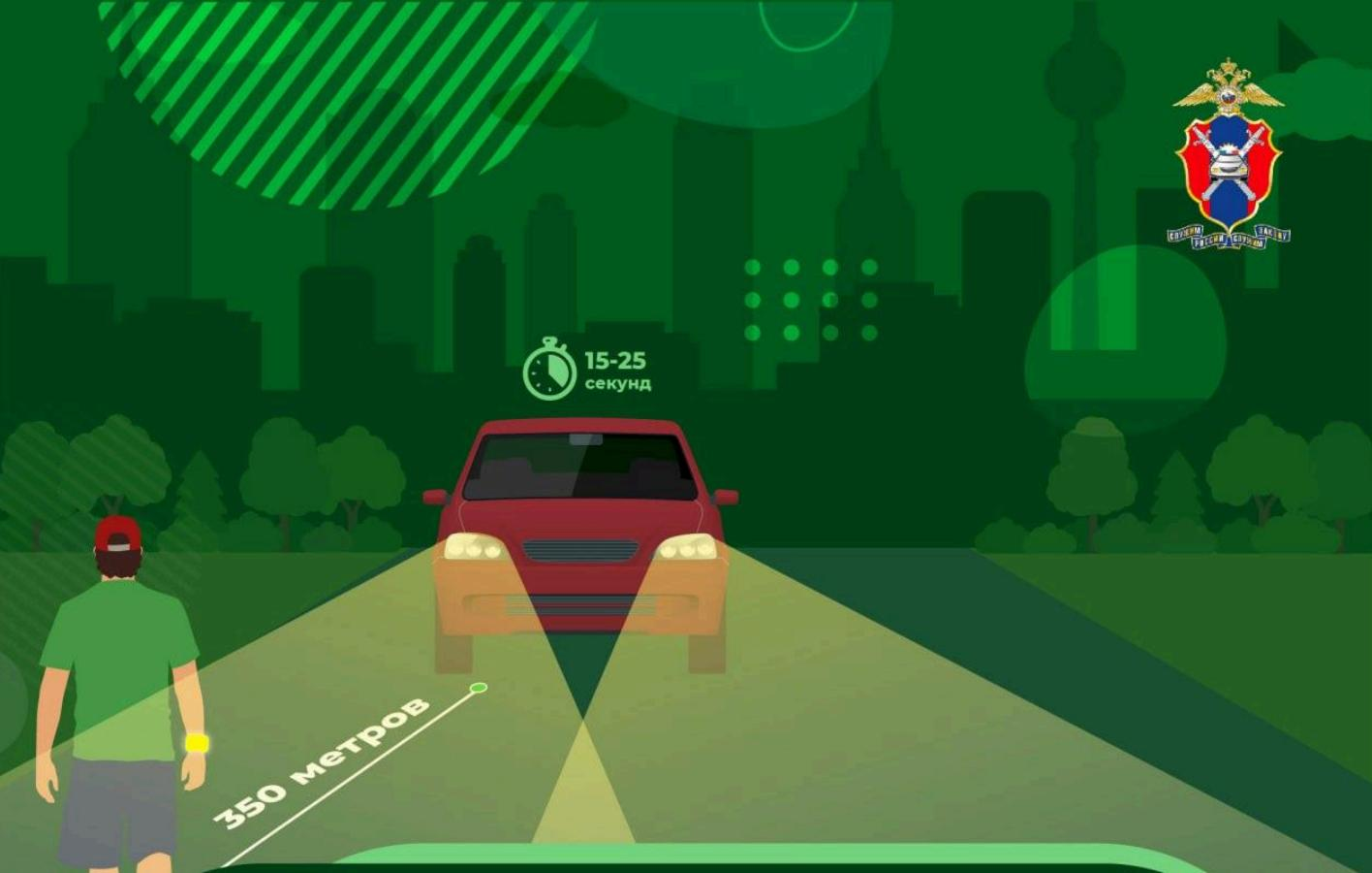
При движении автомобиля с дальним светом фар дистанция, на которой пешеход становится виден, **с применением световозвращателей** увеличивается со **100 метров** до **350 метров**. Это даёт водителю **15-25** секунд для принятия решения
