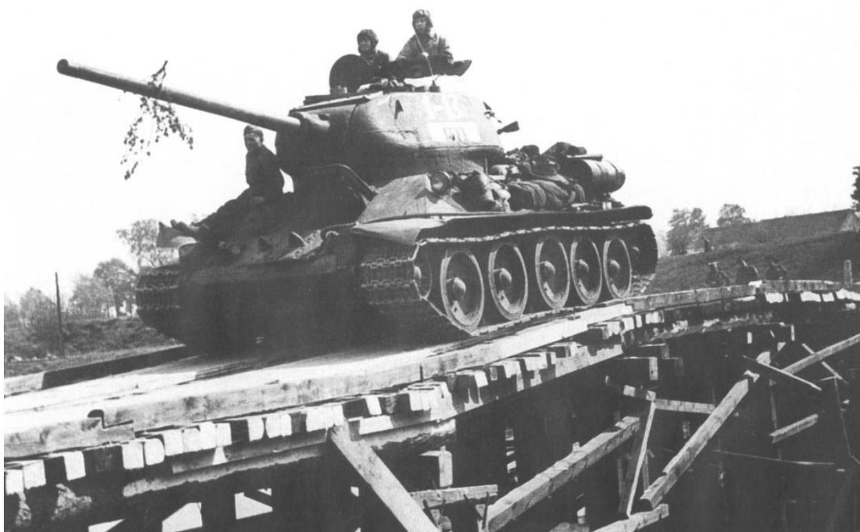
Для того, чтобы исправить ситуацию и вернуть паритет, необходимо было кардинально изменить средний танк «Т-34». Таким танком, способным практически на равных дать бой любому танку вермахта, стал «Т-34-85». Он был создан на базе танка «Т-34» и имел литую башню с 85-мм пушкой. Его боевая масса составляла 32 т. Он вмещал до 5-ти человек экипажа. Помимо пушки танк был оснащён двумя 7,62-мм пулемётами. Танки «Т-34-85» широко использовались во всех сражениях завершающего этапа войны.
