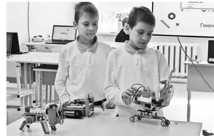
Учащиеся 4 класса Назар и Захар Кукушкины демонстрируют собранные ими модели роботов, в которых использовали датчики положения, расстояния, инфракрасный, RGB-светодиод, кнопку нажатия
