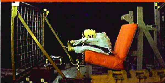
Результаты тестов использования небезопасных удерживающих устройств*
