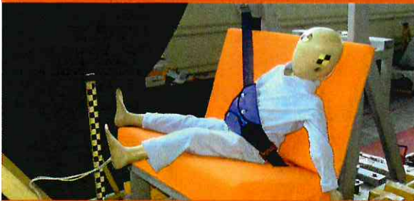
Результаты тестов использования небезопасных удерживающих устройств*
