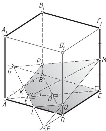
Пусть  $O$  — центр грани  $ABCD$ ,  $E$  — точка пересечения отрезков  $KL$  и  $AC$ . Поскольку  $E$  и  $M$  — общие точки секущей плоскости и плоскости  $AA_1C_1$ , эти плоскости пересекаются по прямой  $ME$ , а поскольку  $KL$  — средняя линия треугольника  $ABD$ , получаем  $CE \perp KL$  и
