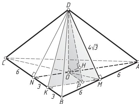
Рассмотрим прямоугольный треугольник  $DPO$ , в нём  $OP = 3$ ,  $DO = 6$ , поэтому  $DP = \sqrt{DO^2 + OP^2} = \sqrt{6^2 + 3^2} = \sqrt{45} = 3\sqrt{5}$ . Пусть  $OH$  — высота этого треугольника, опущенная из вершины прямого угла при вершине  $O$ . Тогда  $OH$  — перпендикуляр к плоскости  $DMK$ , а искомое расстояние  $d$  равно длине отрезка  $OH$ . Следовательно,
