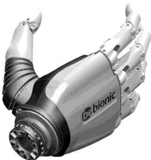
Рис. 10. Биоуправляемый протез кисти руки.
