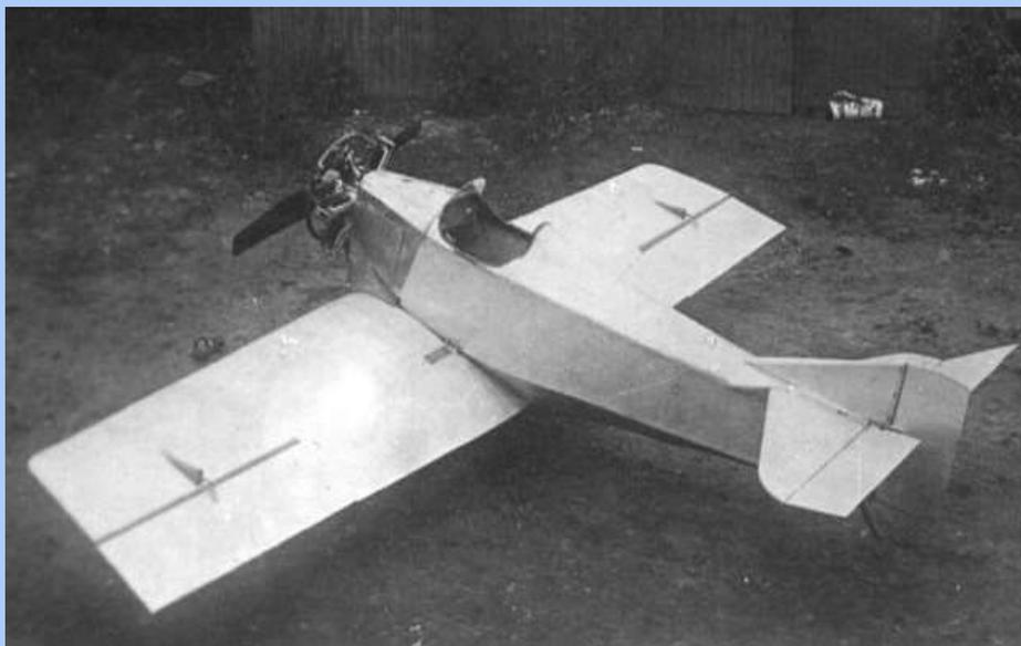
Спортивный самолет АНТ-1 стал не только первым самолетом конструктора А.Н. Туполева, но и первым цельнометаллическим самолетом у нас в стране.
