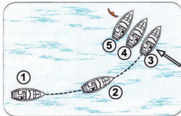
Схема подхода на маломерном судне к тонущему при наличии ветра сводится к тому, чтобы человек в воде оказался с подветренной стороны, а судно было остановлено (легло в дрейф) за 5 - 7 метров при свежем ветре (за 2 - 4 метра при слабом ветре) до тонущего и направление на него составляло 60 - 70°. При этом во время дрейфа маневрировать следует веслом, не прибегая к работе двигателем.
