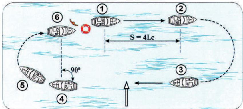
После подачи спасательного круга судно проходит по прежнему курсу расстояние равное примерно четырехкратной длине его корпуса. Затем руль перекладывается на борт и после поворота на 180° судно ложится на обратный курс. Когда тонущий окажется строго на траверзе, руль перекладывается в его сторону и, как правило, в конце циркуляции место бедствия окажется прямо по курсу.
