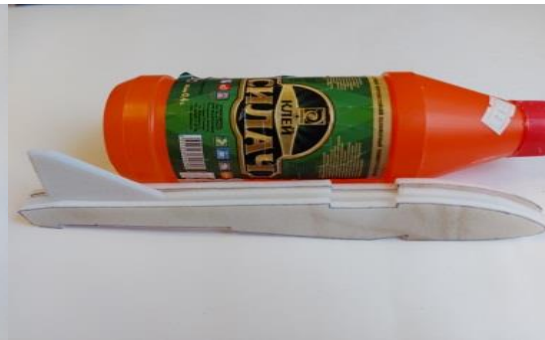
6. Сборка фюзеляжа (склеивание)
