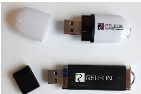
Рис. 5. Общий вид USB-флеш-накопителя (внизу) и Bluetooth-адаптера (вверху)
