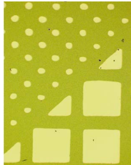
Поверхность керамики ЦТС с электродами
