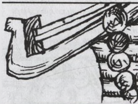
илл. 1/8 Курицы – обработанные в виде птиц или зверей концы еловых жердей
