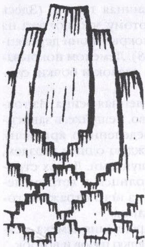
илл. 2/8 Лемех: деревянные "чешуйки", служившие для покрытия криволинейных элементов кровли.
