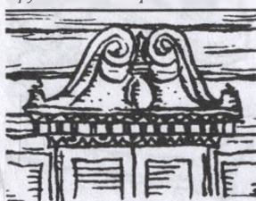
илл. 1/11 Окно с наличниками, которые не только являются украшением избы, но и прикрывают лаз между брусом окна и бревном стены
