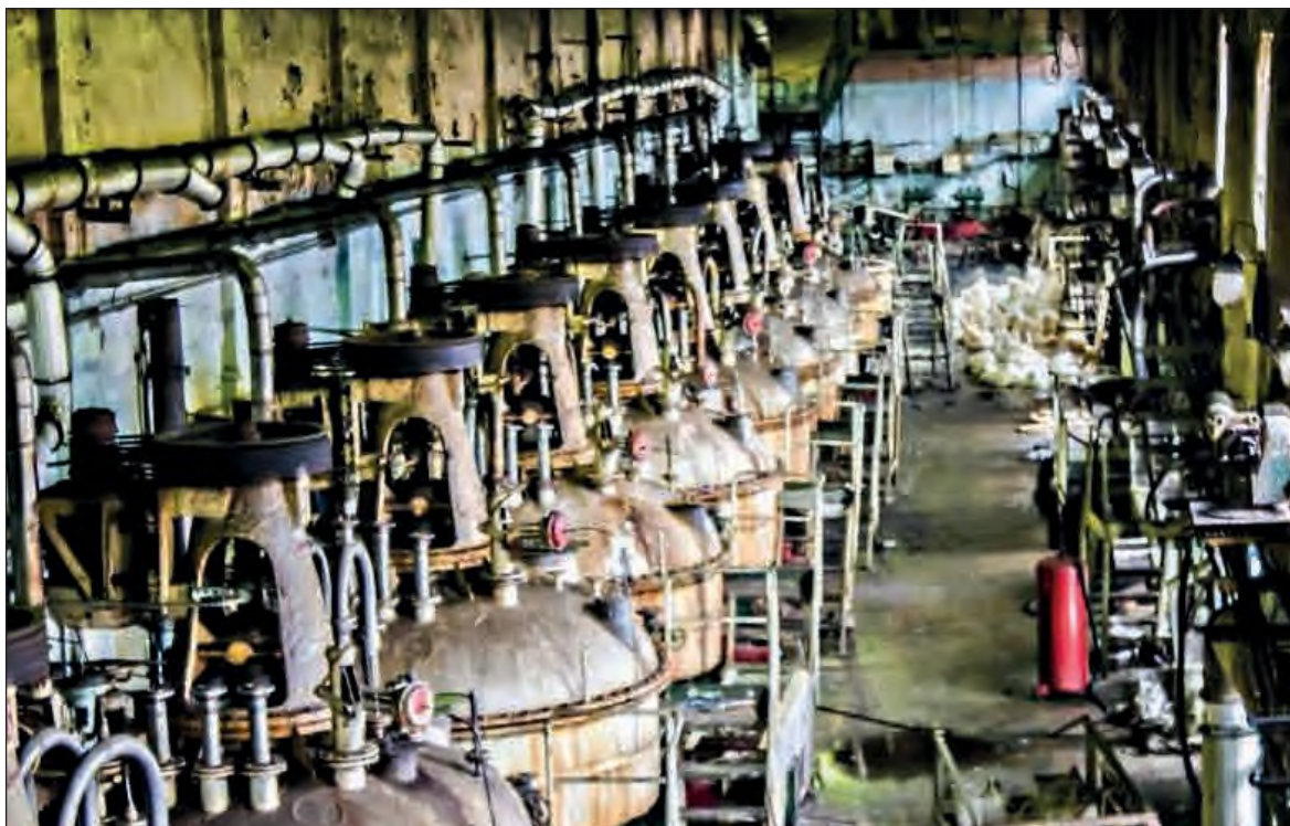
Цех № 2: мастерская нитрации (начальная стадия производства тротила).
