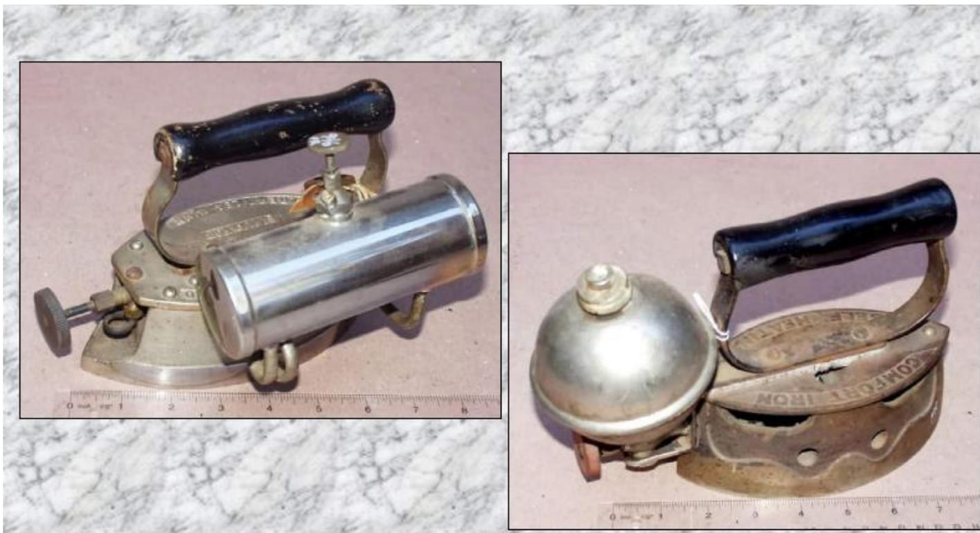
В 19-м веке был изобретен газовый утюг - сложное сооружение, напоминавшее маленький заводик. В корпус такого утюга была вставлена металлическая трубка, подсоединенная другим концом к газовому баллону, а на крышке утюга располагался насос.
