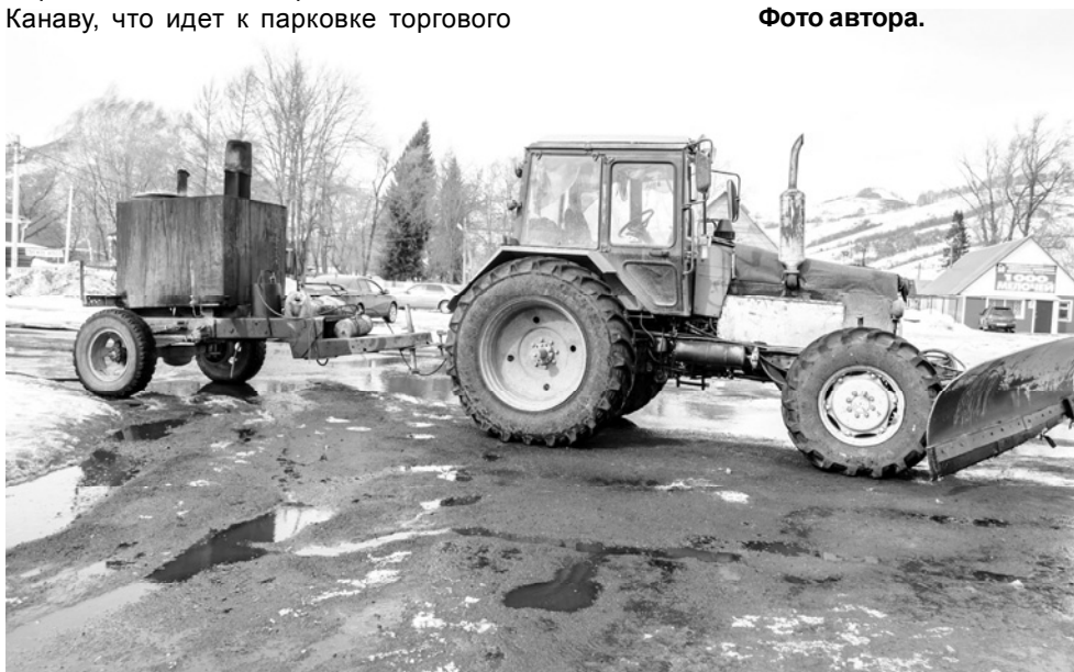
Установка для пропаривания труб.
