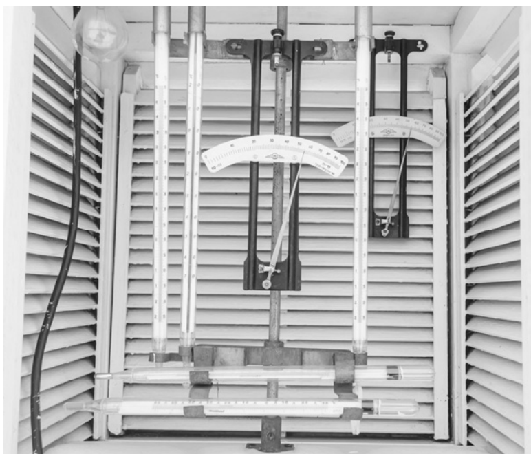
В психрометрической будке снимают показания температуры и влажности воздуха.
