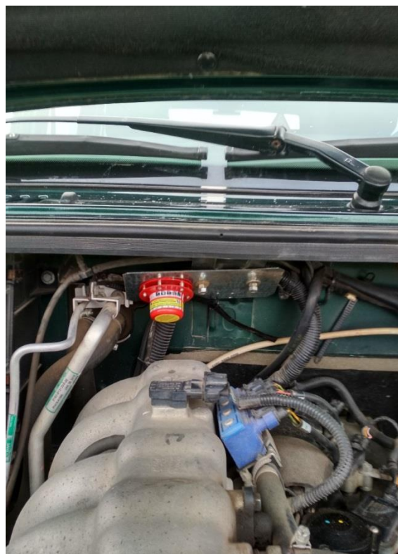
Рисунок 27 Система пожаротушения подкапотного пространства автотранспорта
