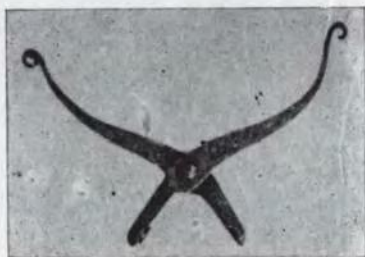
Илл. 27. Пулелейка (колыбь) — приспособление для отливки свинцовых пуль. Вологодская губерния. 2-я половина XIX века (Государственный Исторический музей).
