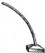
Рис. 30. Колотушка для раздробления стеблей конопли (А. В. Соколовский. «Конопля, разведение ее и переработка». Л., 1925, стр. 73)
