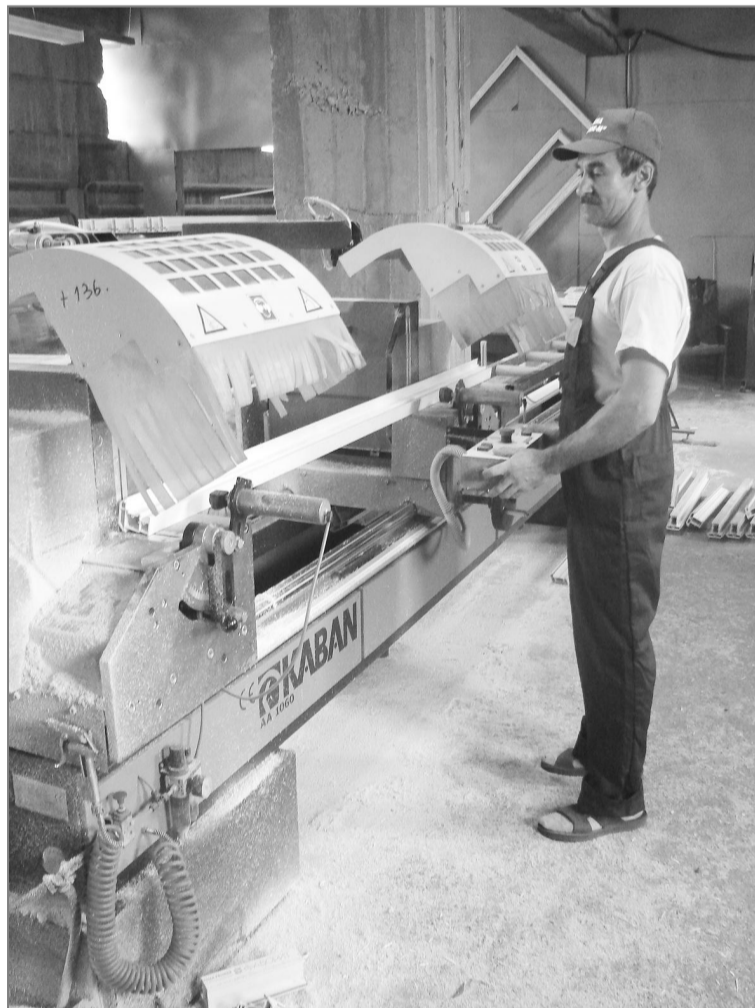
Мастер цеха Владимир Кобзев ведет распиловку профиля. Именно с этого и начинается производственный процесс изготовления пластиковых окон.
