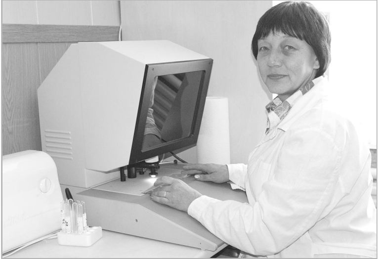
Наталья Борисовна БУСС, главный ветврач, начальник отдела ветсанэкспертизы управления ветеринарии по Троицкому району, за работой на трихинеллоскопе – аппарате, с помощью которого обнаруживают личинки трихинелл.
