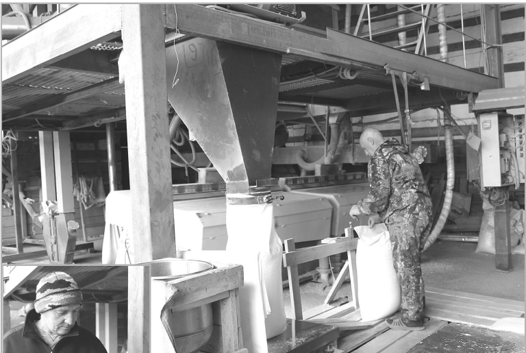
Готовую продукцию, «Геркулес» и овсяную крупу, расфасовывают по мешкам весом 35 и 50 килограммов.
