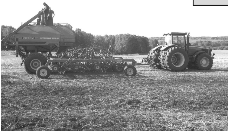
Seed Hawk агрегируется с трактором John Deere 8420 мощностью 270 л.с.
