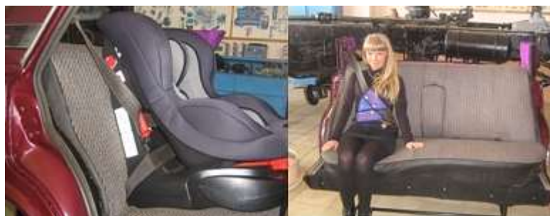
Рисунок 1 - Крепление ДУУ с автомобильным ремнем безопасности
