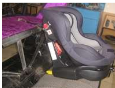
Рисунок 2 - Крепление ДУУ с системой «ISOFIX»
