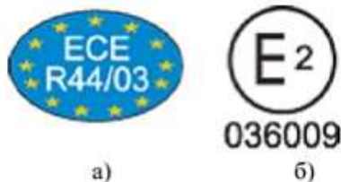
Рисунок 5 - Знаки, проставляемые на детских удерживающих устройствах (а - знак соответствия Европейским нормам ECE R44/03; б - знак официального утверждения (цифра означает код страны: 1 – Германия, 2 – Франция, 3 – Италия и т.д.; число снизу – номер официального утверждения))
