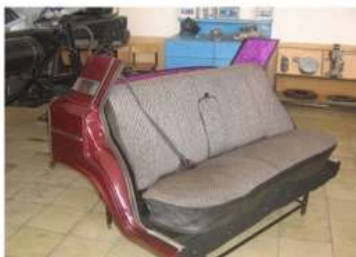
Рисунок 3 - Стенд для демонстрации и обучения установке детских автомобильных кресел:
