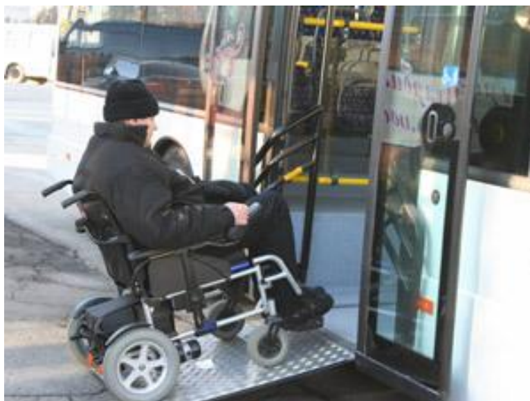
Рисунок 25 Организация посадки в низкопольный автобус инвалида-колясочника
