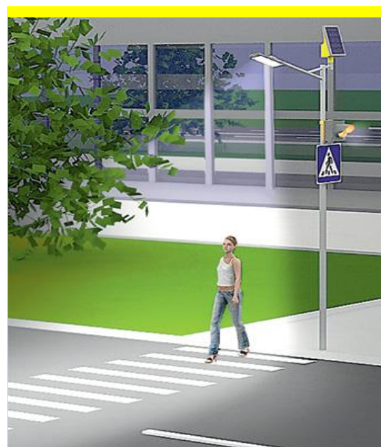
Рисунок 29 Комплект освещения пешеходного перехода на солнечных электростанциях
