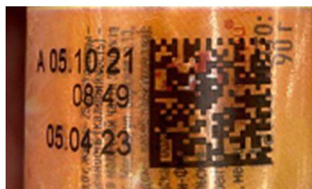
Печать кода маркировки на бликующей/светоотражающей поверхности
