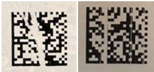
Нарушение целостности КМ*
