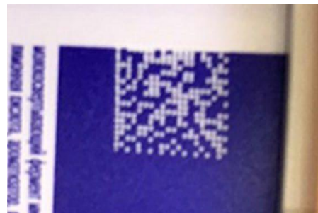
Отсутствие зоны покоя с одной из сторон
