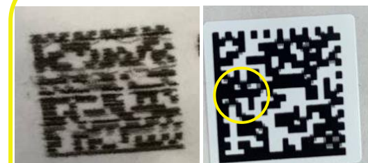
Смазывание кода маркировки или его отдельных элементов
