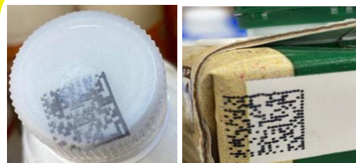
Смещение кода маркировки при печати
