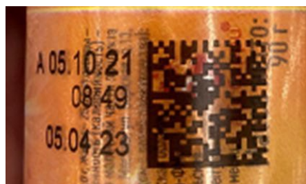
Печать кода маркировки на бликующей/светоотражающей поверхности
