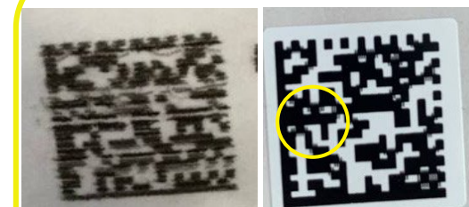
Смазывание кода маркировки или его отдельных элементов
