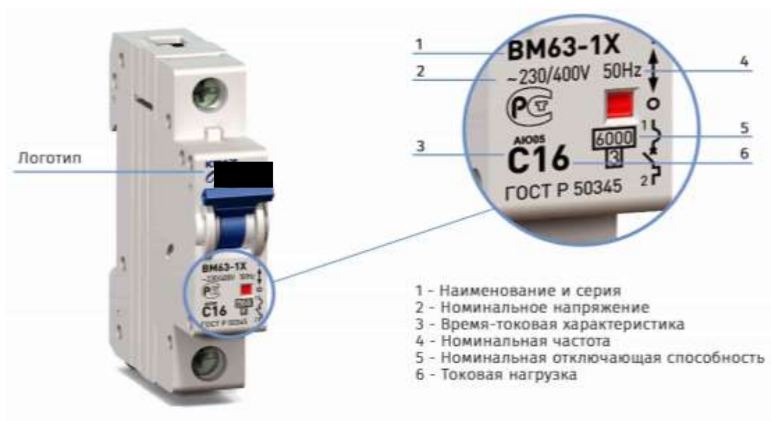
Рисунок 2. Пример маркировки АВ
