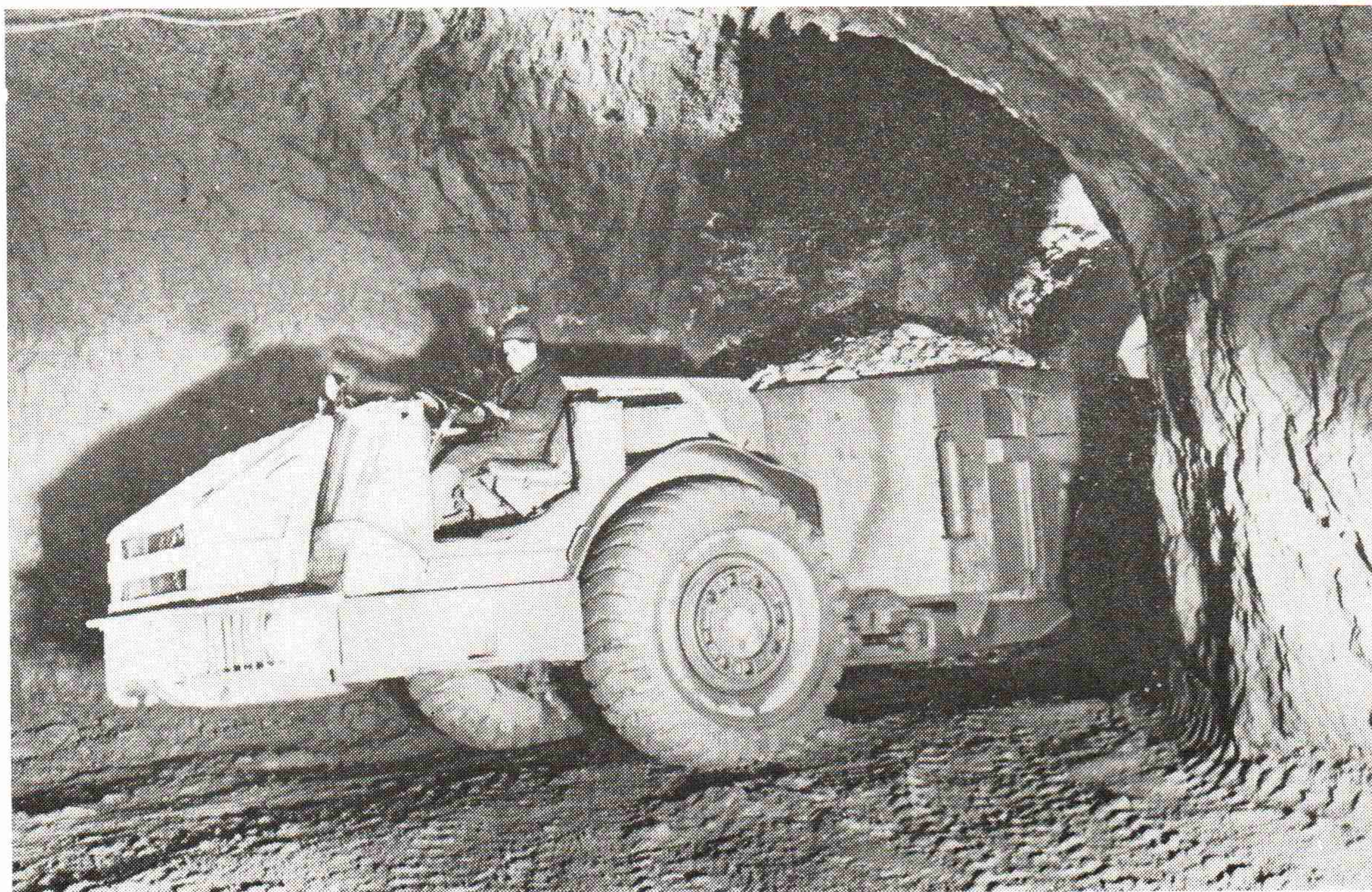
Транспортировка руды из забоев автосамосвалом МоАЗ-64011
