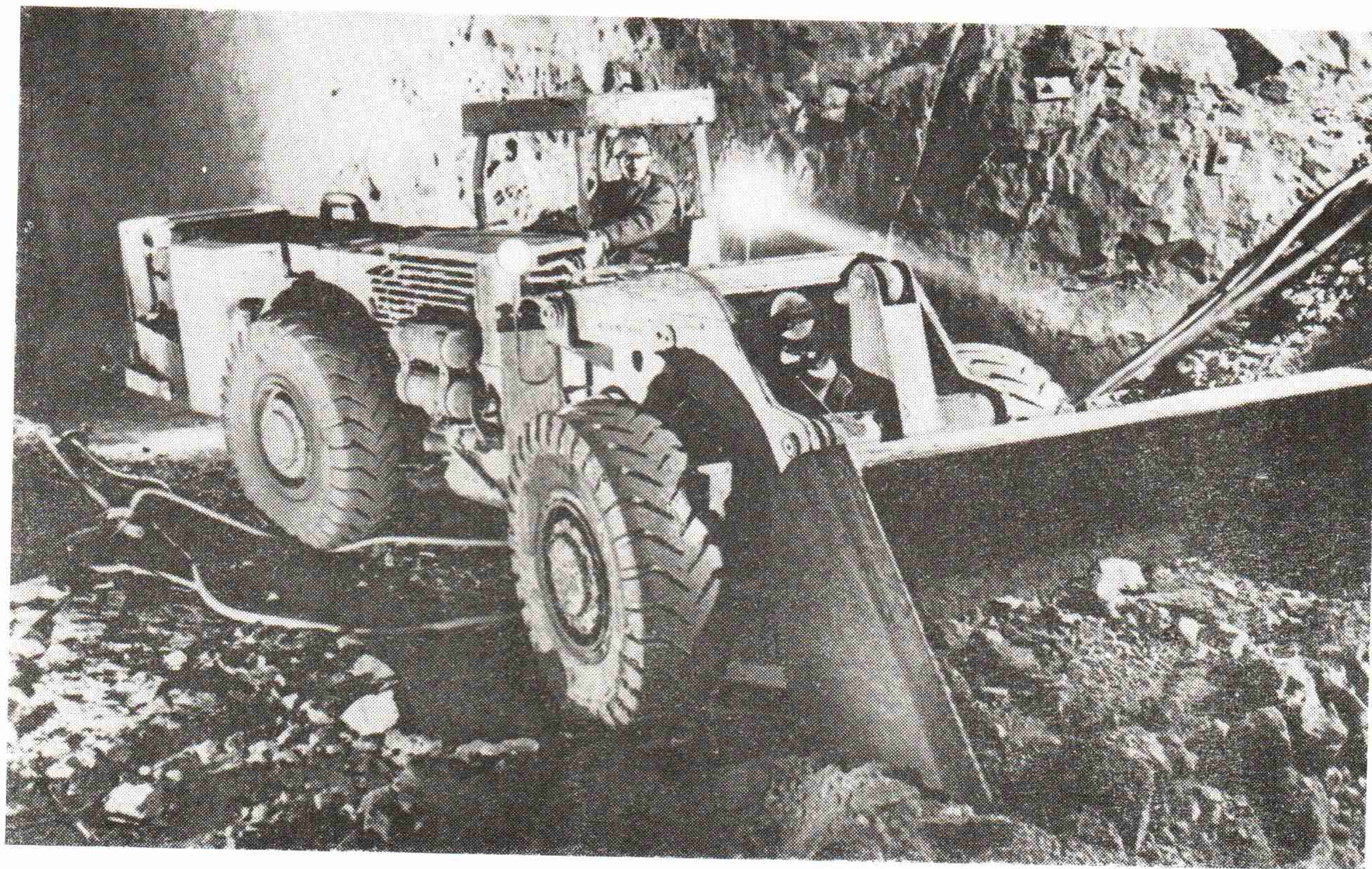
Погрузочно-доставочная машина с дизельным приводом в очистном забое
