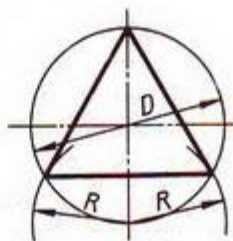
Разделить окружность на 3 и 6 равных частей
