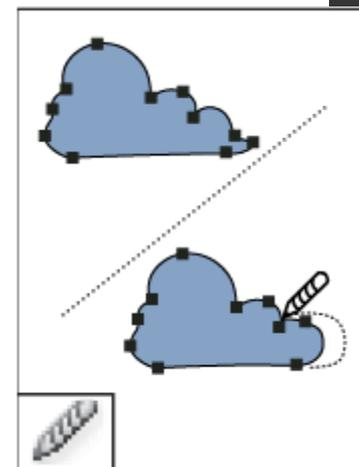
Инструмент "Сглаживание" позволяет удалить из контура лишние углы.
