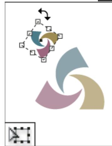
Инструмент "Свободное трансформирование" позволяет поворачивать, изменять размер или наклон объекта.
