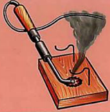
Отсутствие несгораемой подставки под электронагревательным прибором
