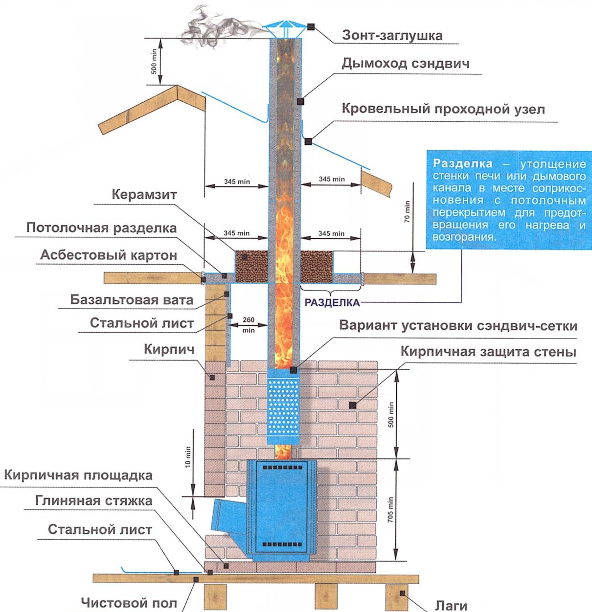
\*Пример установки отопительной печи и выполнения разделки дымовой трубы «сэндвич»
