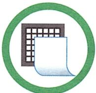
Перед включением газового оборудования необходимо дважды **ПРОВЕРИТЬ ТЯГУ** в дымоходе (перед и во время его эксплуатации). Для проверки вытяжной вентиляции поднесите листок бумаги к вентиляционной решетке, если **ЛИСТ УДЕРЖИВАЕТСЯ НА РЕШЕТКЕ — ВЕНТИЛЯЦИЯ В РАБОЧЕМ СОСТОЯНИИ**.
