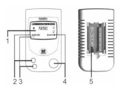
На рисунке 1, представлен внешний вид индикатора радиоактивности РАДЭКС РД 1503, который предназначен для обнаружения и оценки уровня ионизирующего излучения. На передней и задней панели прибора находятся: 1. ЖК – дисплей.
