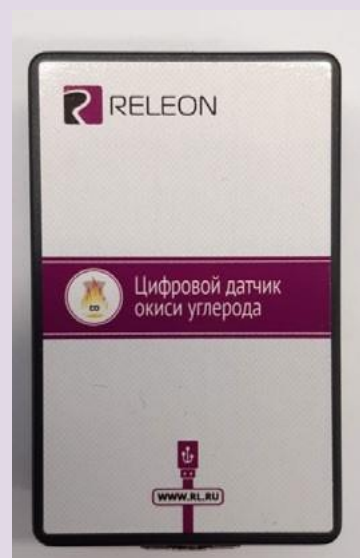
Рис. 11. Датчики кислорода (слева) и угарного газа (справа)
