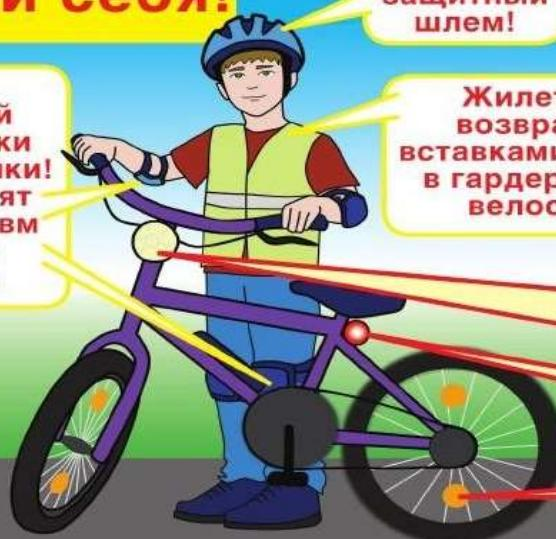
Велосипед должен иметь исправные тормоз, быть оборудован спереди световозвращателем и фонарём или фарой (для движения в тёмное время суток и в условиях недостаточной видимости) белого цвета, сзади — световозвращателем или фонарём красного цвета, а с каждой боковой стороны — световозвращателем оранжевого цвета.
