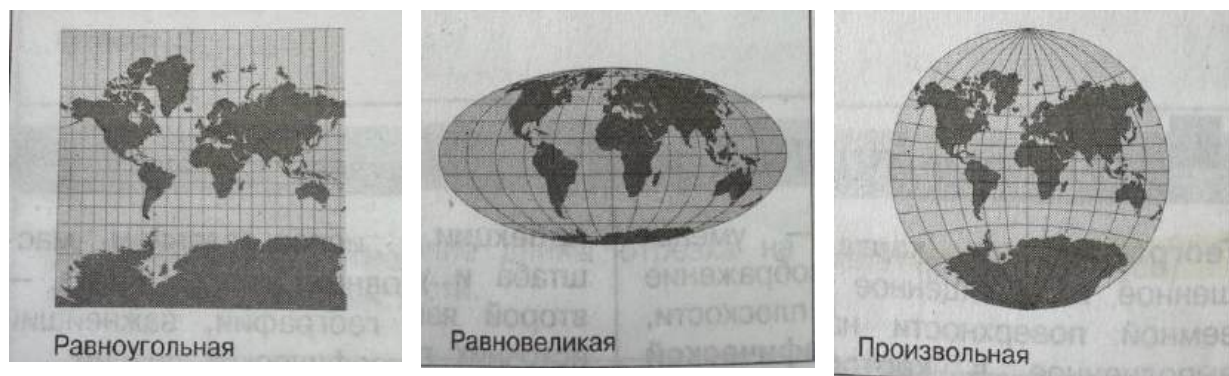
Рисунок 1.2 – «Типы проекций по характеру искажений»
