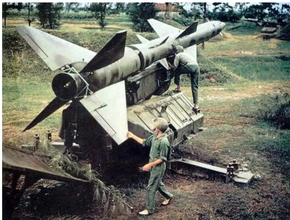
Рис. 11. С-75 – советский мобильный зенитный ракетный комплекс (ЗРК), принятый на вооружение в 1950-х годах
