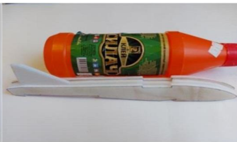
6. Сборка фюзеляжа (склеивание)
